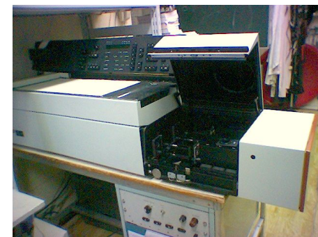
Двухлучевой спектрофотометр "Specord-M40". \lambda=(185\div900) нм, \pm 0.3 нм. Погрешность воспроизведения - не более \pm 0.1 нм. 0.05; 0.1; 0.2; 1; 2; 5; 10 нм/с. Диапазон спектральных шагов - 0.05 ... 5 нм. Приставка для измерения флуоресценции к спектрофотометру SPECORD M40
