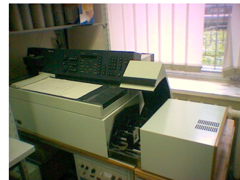
Двухлучевой спектрофотометр "Specord-M40". \lambda=(185\div900) нм, \pm 0.3 нм. Погрешность воспроизведения - не более \pm 0.1 нм. 0.05; 0.1; 0.2; 1; 2; 5; 10 нм/с. Диапазон спектральных шагов - 0.05 ... 5 нм. Приставка для измерения флуоресценции к спектрофотометру SPECORD M40
