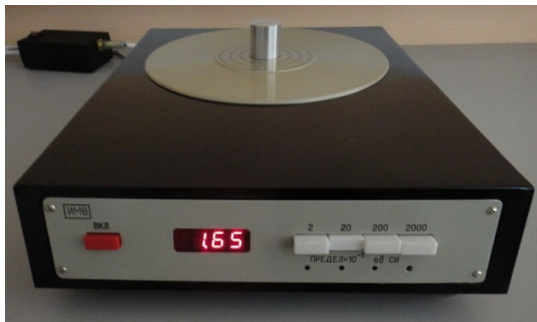
“ИМВ” – магнитометр для измерения магнитной восприимчивости
