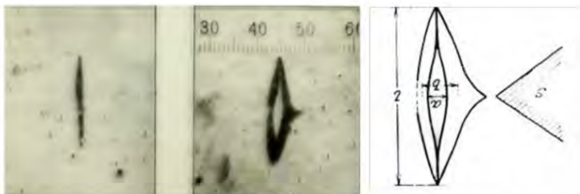
Рисунок 4: Наблюдаемый рисунок на пластине детектора: слева без магнитного поля, посередине с магнитным полем и справа геометрия пятна луча вблизи края магнита. Поскольку напряженность магнитного поля быстро уменьшается с расстоянием от края магнита (перпендикулярно направлению В-поля), компоненты луча сливаются. (Изображения из частной коллекции слайдов Штерна, Gy-UBFAZ, см. также (Gerlach and Stern, 1922b, стр. 350, 351))
