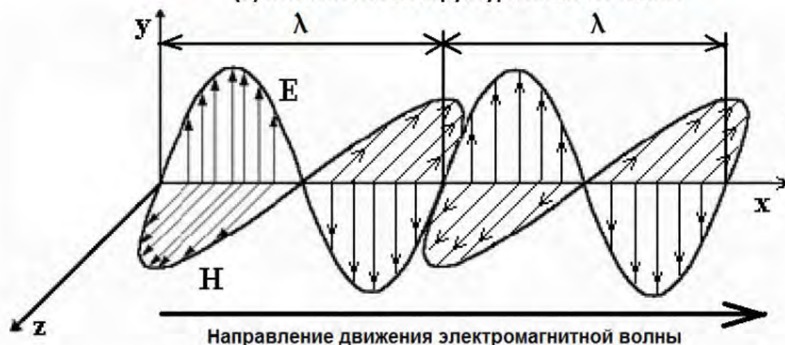
(б) Распределение электрической E и магнитной H напряженностей
