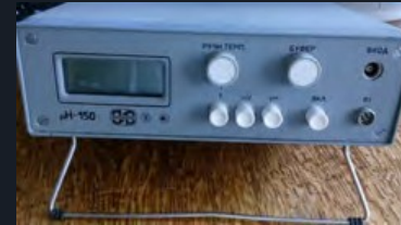
Рис.2. pH-150 рН-ОВП-Т метр
