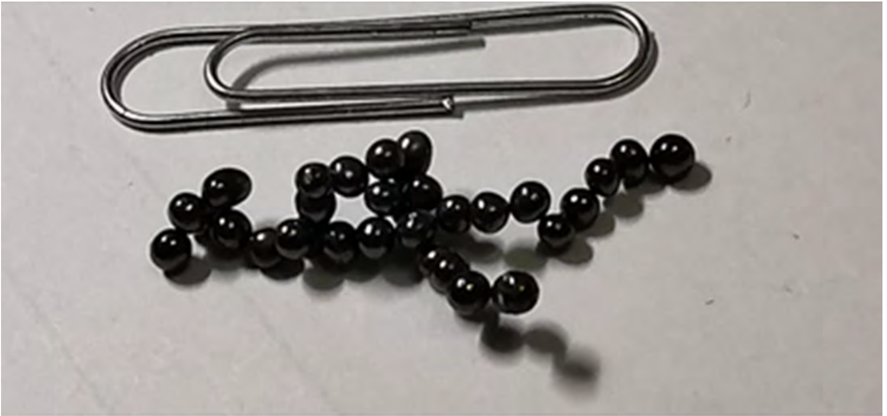
Фрагмент трехмерной проводящей дорожки, образованной спеканием шариков импульсным сигналом
