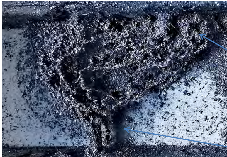
Рис.3. Нейроморфная древовидная порошковая структура, отображающая входной образ
