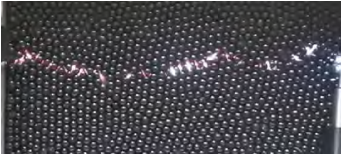
Рис.2. Кадр скоростной съемки процесса формирования проводящего канала
