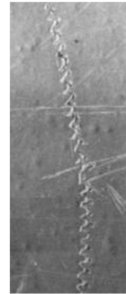
М. И. Солин, поверхность застывшего расплава циркония, электронно-лучевая плавка, E \sim 30 кэВ.
