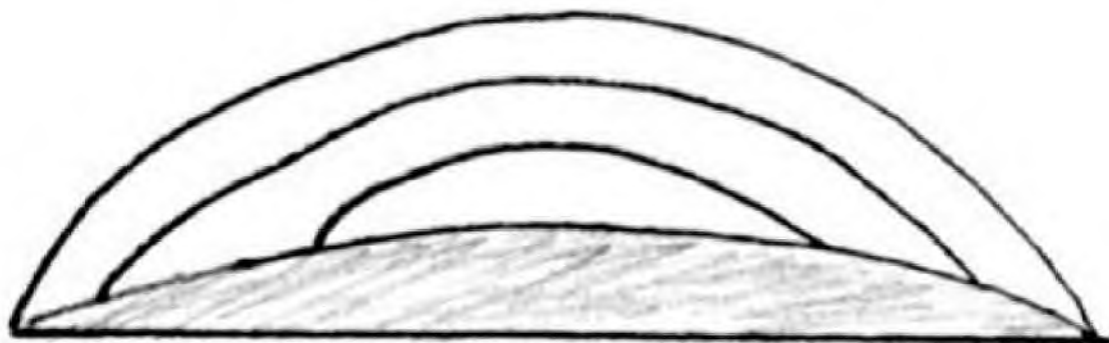
Рис. 1-12. Изменение формы капли от времени для раствора белка при отсутствии перемешивания. Имеется залипание границы (пиннинг).
