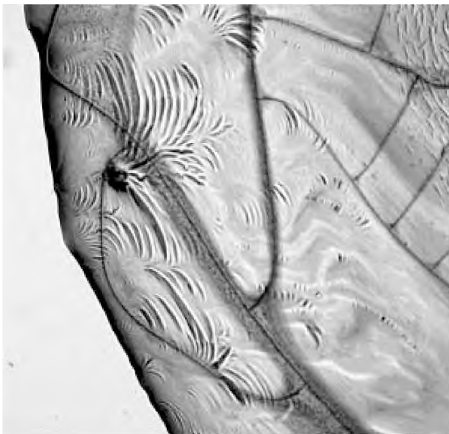
Рис. 1-26. Морщины в краевой зоне капли. Боковое освещение. Поле зрения 2 мм.
