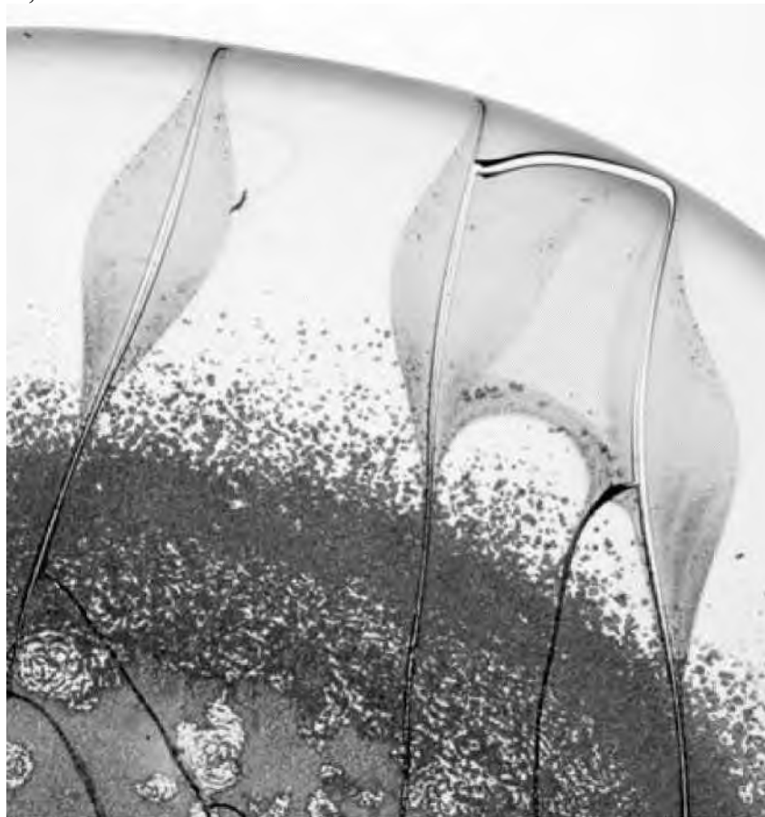
Рис. 1-56. Структура типа «лист» в сформированной капле. Поле зрения 2 мм.
