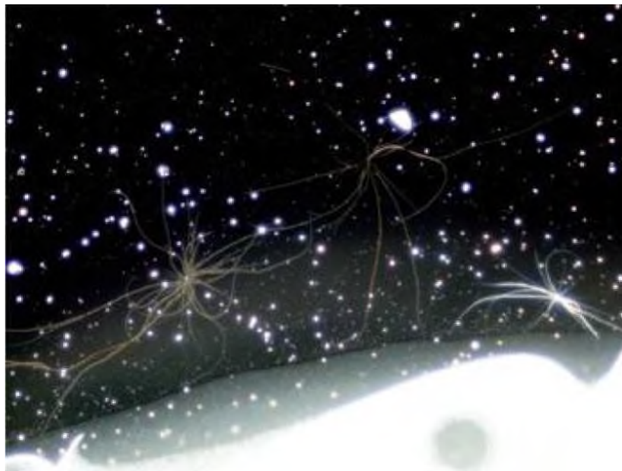
Рис. 1-69. Кристаллы внешние - нитевидные. Темное поле. Поле зрения - 1.5 мм.
