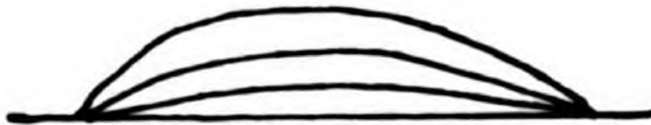
Рис. 1-11. Изменение формы капли от времени для вязкой жидкости (раствор сахара).
