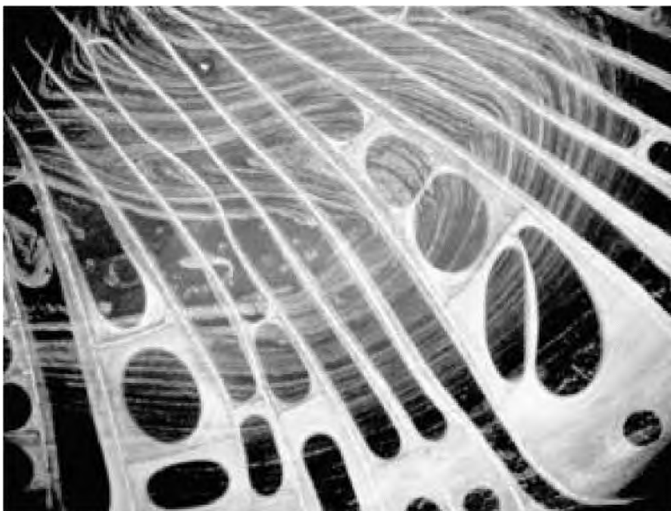
Рис. 1-27. Структуры на поверхности капли. Темнопольное освещение. Поле зрения 3 мм.
