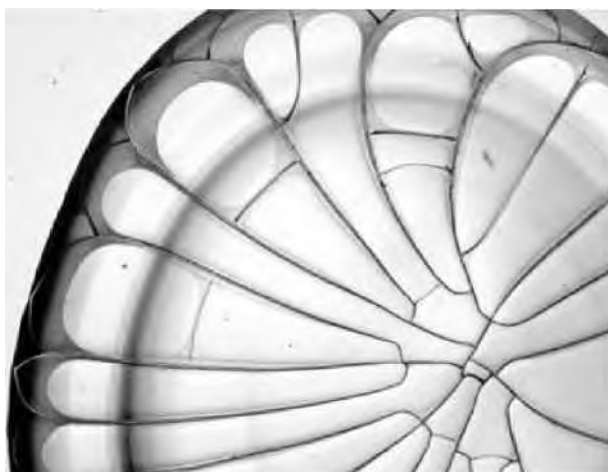
Рис. 1-38. Движение фронта трещин. Поле зрения 4 мм. Снимки сделаны через 20, 30 и 32 мин после начала дегидратации.
