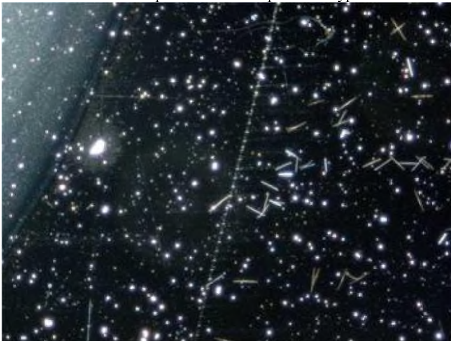
Рис. 1-68. Кристаллы внешние - иглы. Темное поле. Поле зрения - 0,7 мм.
