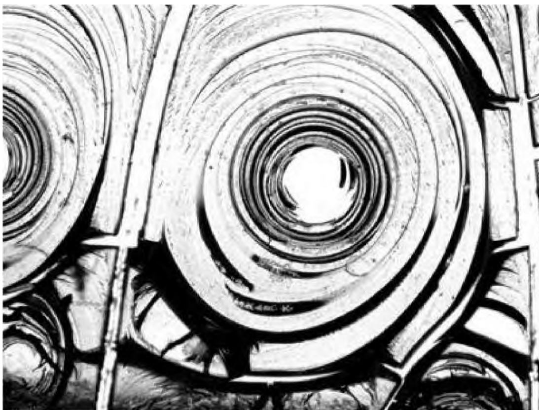
Рис. 1-58. Концентрические трещины в ячейке. Поле зрения 0,3 мм.
