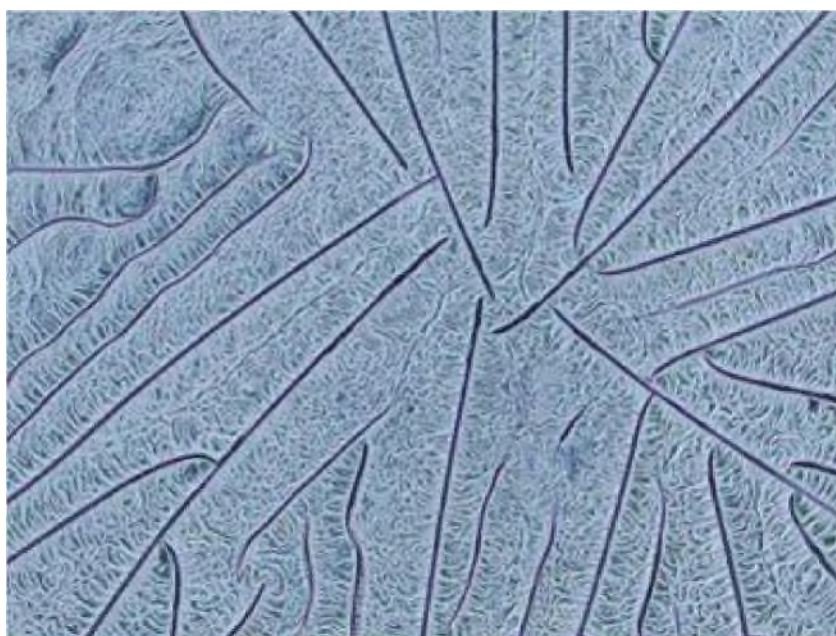
Рис. 1-43. Трещины и узкие псевдотрещины. Светлое поле, темное поле, фазовый контраст. Поле зрения 2 мм.
