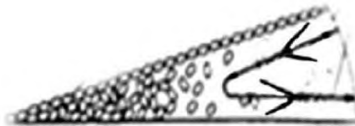
Рис. 1-28. Осаждение альбумина с краю высыхающей капли, образование белкового валика.
