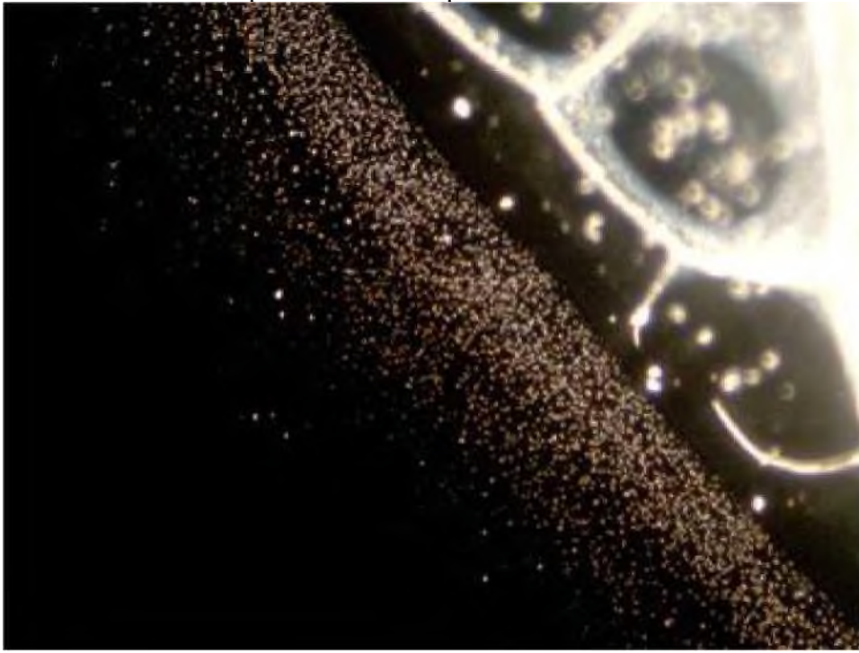
Рис. 1-67. Кристаллы внешние - точечные. Темное поле. Поле зрения 0,7 мм.
